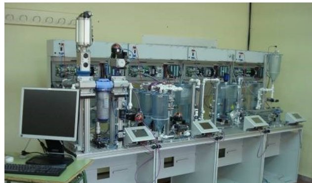
Equipo didáctico para la formación en automatización en procesos continuos (Simulación de plantas químicas y de proceso)
